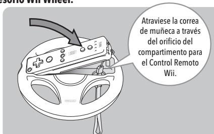
Atraviese la correa de muñeca a través del orificio del compartimento para el Control Remoto Wii.
