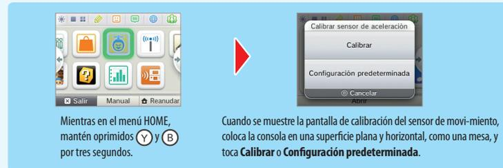
**NOTA:** si eliges la opción **Calibrar**, el sensor de movimiento se calibrará tomando por hecho que la consola está en una superficie plana y horizontal, y no se restaurará la configuración predeterminada.
